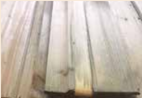
Färgskiftningar orsakade av UV-strålning och förpackningstejp.
