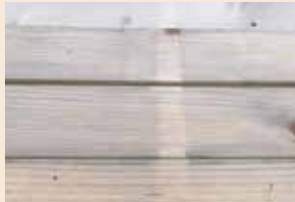
Färgskiftningar orsakade av UV-strålning och förpackningstejp.
