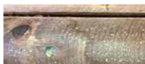
Соли пропитки на поверхности древесины.
