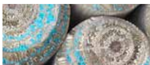
Соли пропитки на поверхности древесины.
