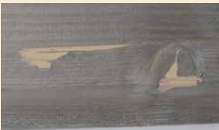
Overflate ferdigbehandlet med trefyll på dyppet trevirke
