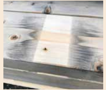
Dyppevæske kommer ikke frem til alle overflater
