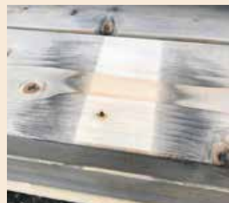
El líquido del baño de inmersión no llega a todas las superficies
