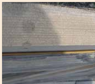
El líquido del baño de inmersión no llega a todas las superficies
