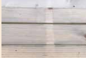
Farbabweichungen, die durch UV-Licht und Verpackungsbänder verursacht sind.
