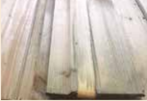
Farbabweichungen, die durch UV-Licht und Verpackungsbänder verursacht sind.
