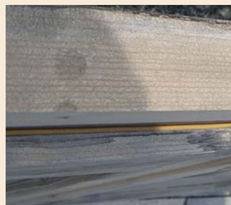
Die Tauchflüssigkeit erreicht nicht alle Oberflächen
