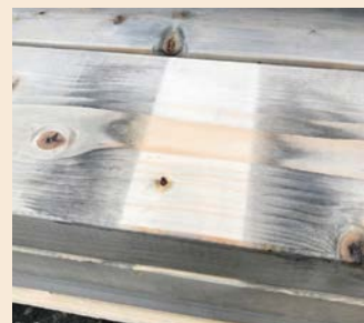
Die Tauchflüssigkeit erreicht nicht alle Oberflächen
