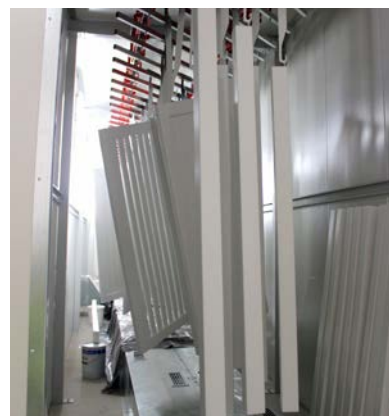
Painted products in drying chamber • Lackierte Produkte in der Trockenkammer • Les produits peints transitent par une chambre de séchage • Productos pintados en la cámara de secado • Prodotti verniciati in camera di essiccazione
