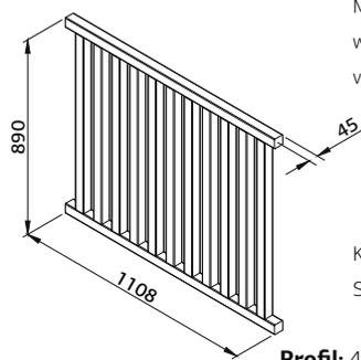
Mit Dübeln und wasserdichtem Leim verbunden
