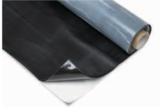
Diese Dachfolie ist einseitig vollflächig mit einem Klebefilm versehen und durch eine Trennfolie auf der Klebefläche geschützt, die vor der Verarbeitung abgezogen wird. Das Rollenmaß beträgt 10 Laufmeter, bei einer Rollenbreite von 1,5 m. Unter der Rubrik Zusatzartikel für Flachdachhäuser, wird die Artikelnummer sowie der Rollenbedarf je Haus aufgeführt.
