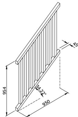
Mit Dübeln und wasserdichtem Leim verbunden
