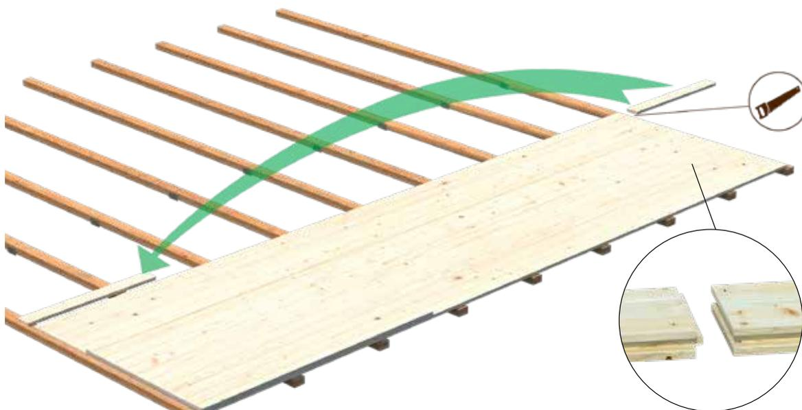
Tenons aux extrémités de lames de plancher
