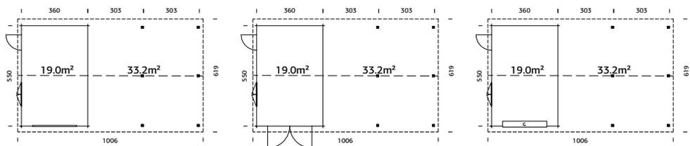
**Information complémentaire**    *Peut être monté dans l'autre sens. Pannes robustes en lamellé collé. Bonne résistance à la charge de neige.*    *Peut être monté dans l'autre sens. Pannes robustes en lamellé collé. Bonne résistance à la charge de neige.*    *Peut être monté dans l'autre sens. Pannes robustes en lamellé collé. Kit de motorisation pour porte sectionnelle en option. Bonne résistance à la charge de neige.*
