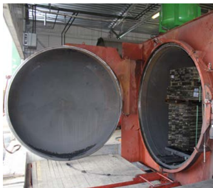
Pressure-treated wooden details in a wood treatment autoclave • Autoklav-Anlage für kesseldruckimprägniertes Holz • Détails en bois traitées en autoclave dans une station d'imprégnation • Detalles de madera tratada en autoclave en un recipiente a presión • Dettaglio del trattamento in autoclave
