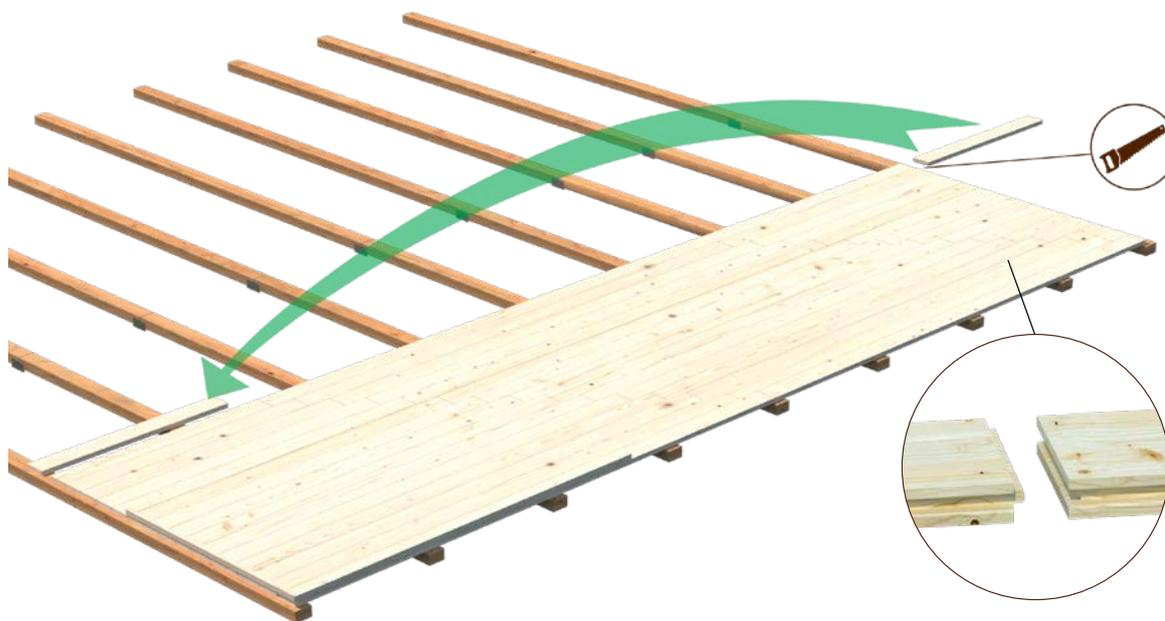
Tenons aux extrémités de lames de plancher
