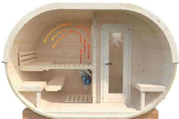
La forme cylindrique et ovale des saunas assure une **bonne circulation de l'air**. La répartition de la chaleur est très uniforme : l'air chaud monte et retombe doucement de chaque côté du sauna. L'air frais est aspiré par l'évent bas grâce au vide créé par la montée de l'air chaud, qui est lui-même évacué par l'évent haut du côté opposé de la pièce.
