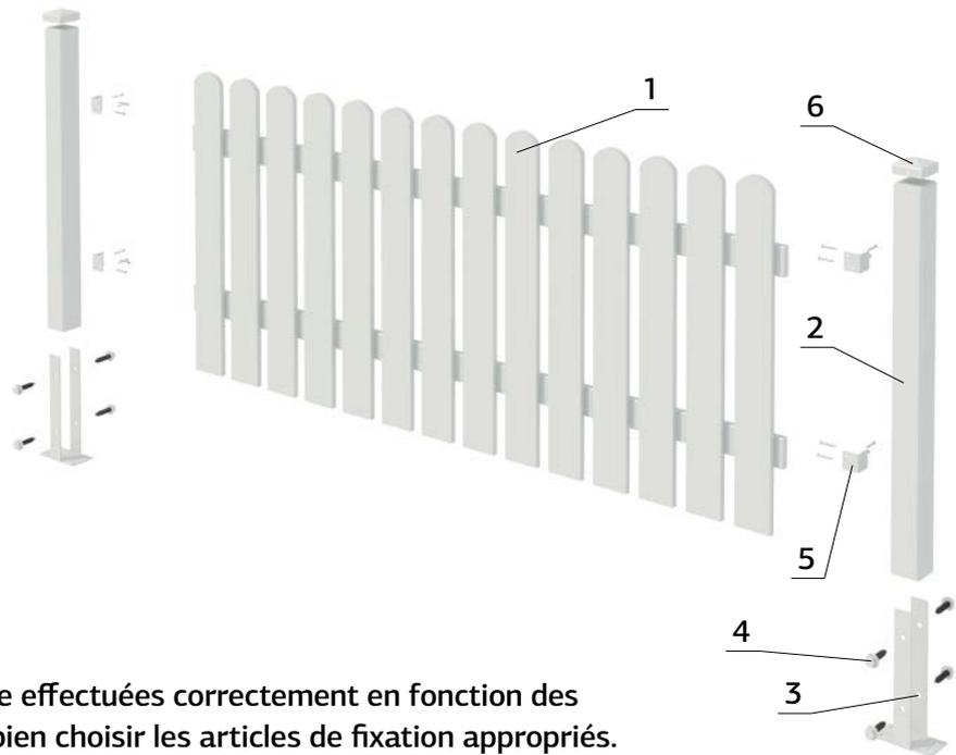
Les fixations au sol doivent être effectuées correctement en fonction des fondations. Faites attention à bien choisir les articles de fixation appropriés.
