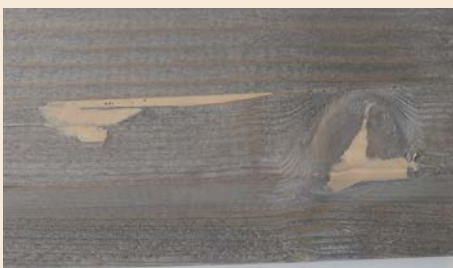
Superficie rifinita con stucco per legno su legno immerso
