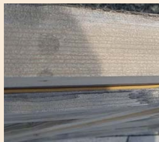
При погружении пропитываются не все поверхности
