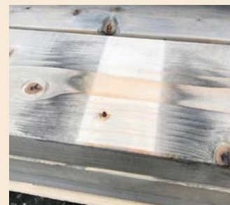
При погружении пропитываются не все поверхности
