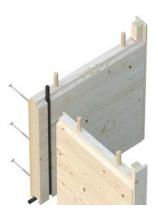
La connexion d'angle des panneaux muraux lamellé-collé est fixée avec des chevilles et sécurisée par des vis.
