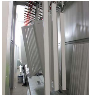
Painted products in drying chamber / Lackierte Produkte in der Trockenkammer / Les produits peints transitent par une chambre de séchage. / Productos pintados en la cámara de secado / Prodotti verniciati in camera di essiccazione / Geschilderde producten in droogkamer
