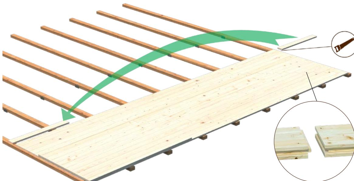
Tenons aux extrémités de lames de plancher
