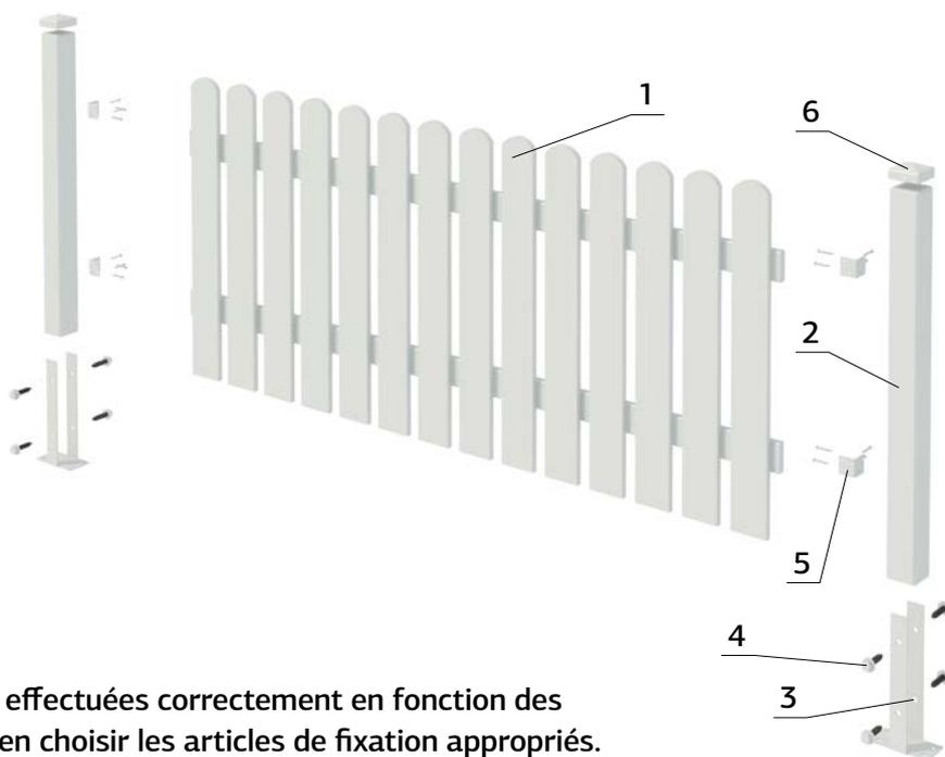
Les fixations au sol doivent être effectuées correctement en fonction des fondations. Faites attention à bien choisir les articles de fixation appropriés.
