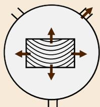
Il legno viene inserito nel serbatoio e ha inizio la fase sottovuoto. L'aria e l'umidità vengono estratte dalle cellule del legno.
