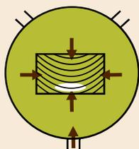
Attraverso la pressione idraulica, il liquido viene pressato nel legno.
