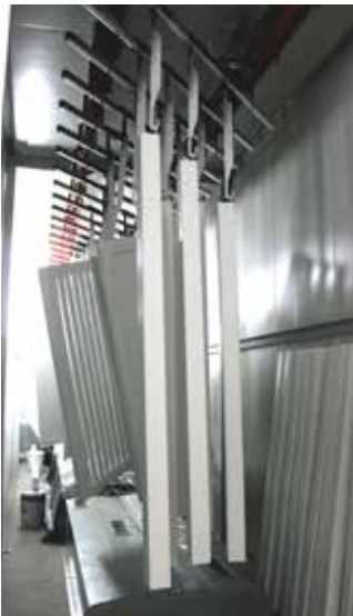
Transit des produits peints dans la chambre de séchage
