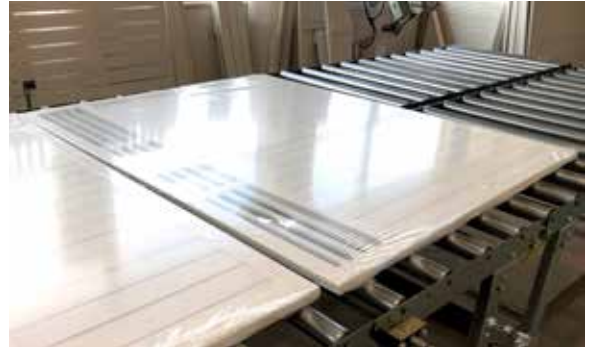
In die Schrumpffolie eingewickelte Zaunpaneele
