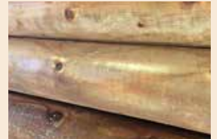
Bei verpackten Pfosten war es für die braune Farbe schwierig, durchzudringen.
