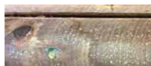
Puupinnalla olevia suolajäämiä.
