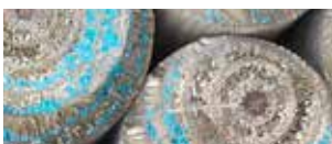
Puupinnalla olevia suolajäämiä.
