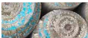
Соли пропитки на поверхности древесины.
